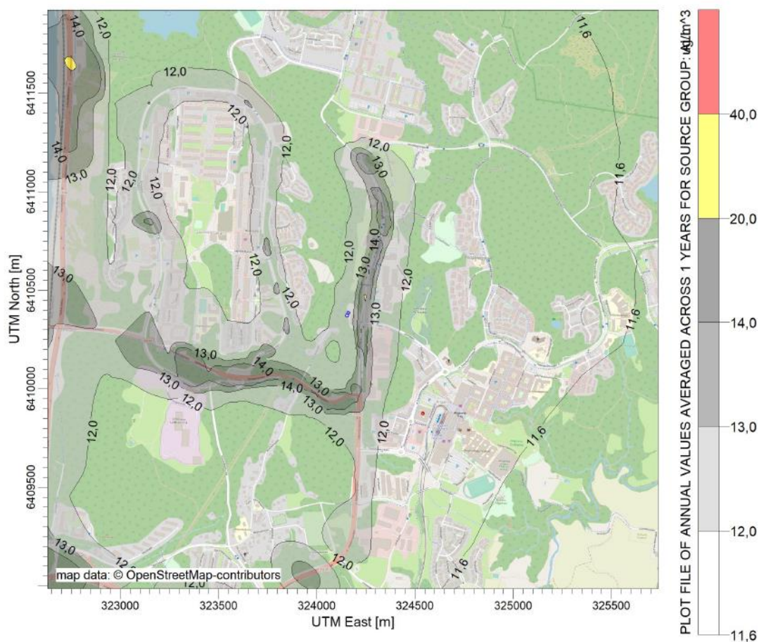
Figur 8: Årsmedelvärde av totalhalt för NO 2 för nollalternativet. Miljömålet för Göteborg stad (gul markering) överskrider i delar av väglinjen nordväst om planerad anläggning. MKN överskrider ej.
